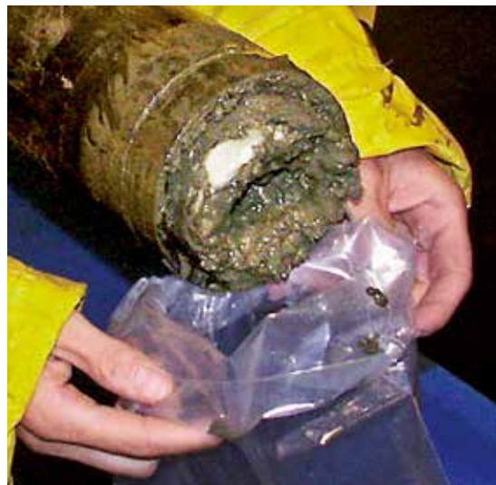
3.13 > Methanhydratbrocken in einem Bohrkern
