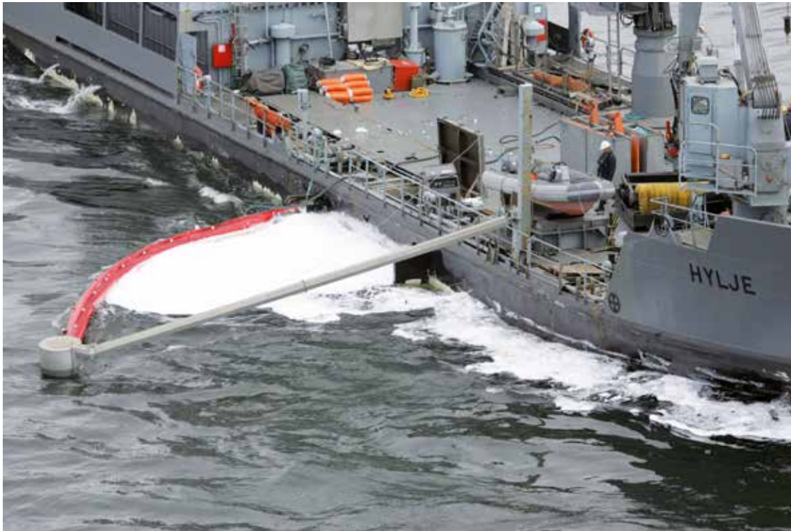
1.45 > Während einer Ölbekämpfungsübung vor Helsinki fängt das Mehrzweckschiff „Hylje“ mit einem Schwenkarm einen Spezialschaum ein, der Öl simulieren soll.
