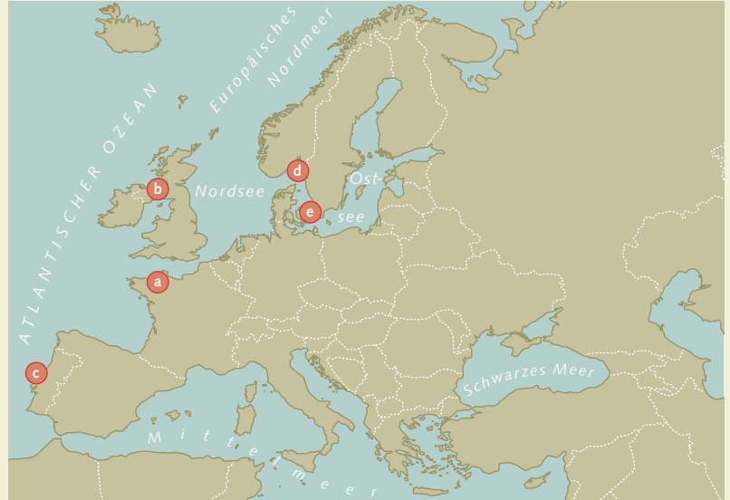
7.12 a > An mehreren Orten in Europa gibt es bereits Anlagen zur Ernte der Meeresenergie. Die älteste ist das La-Rance-Gezeitenkraftwerk bei Saint Malo in Frankreich, das bereits in den 1960er Jahren errichtet wurde. Mit einer Leistung von 240 Megawatt war es lange das größte seiner Art.
